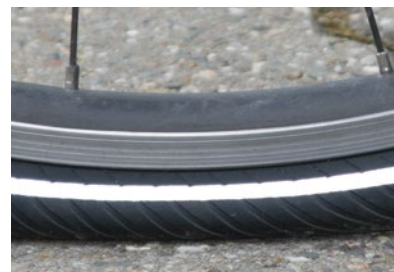
So nicht. Hier ist der Luftdruck bereits viel zu gering.
