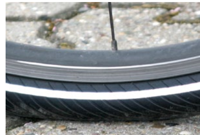
So sollte es aussehen. Der Reifen ist unter der Last des Fahrers kaum verformt.
