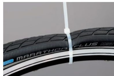
Ein Kabelbinder als helfende dritte Hand
